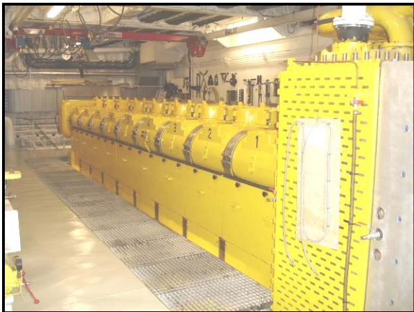
Abb.: 2. Das Schiff besitzt außerdem zwei Hilfsmotoren, die mit Marinedieselöl (MGO, Abk. für Marine Gas Oil) betrieben werden und die die Elektrizität für das Schiff liefern, siehe
